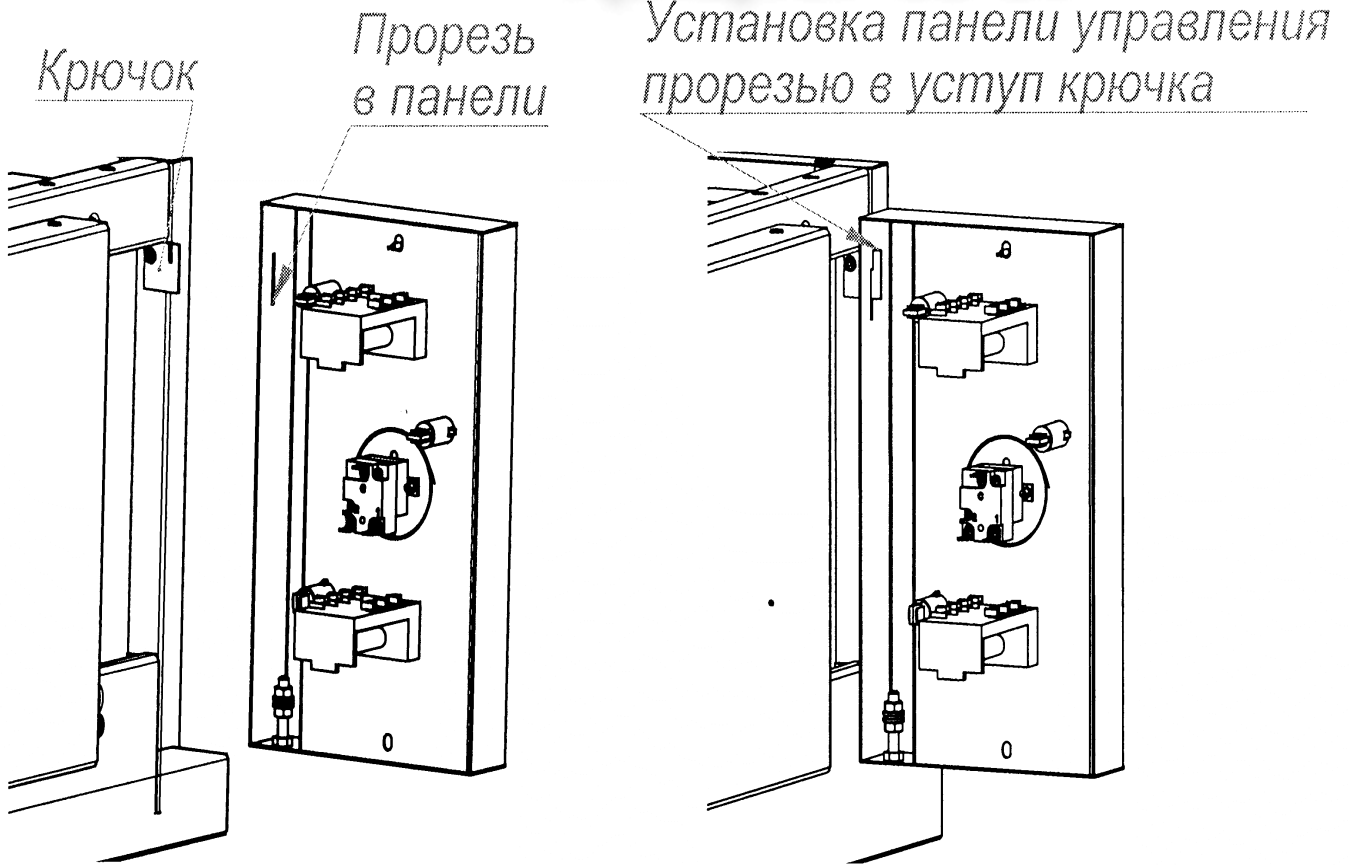
Рис. 5. Технологическое окно для замены контрпетли.
